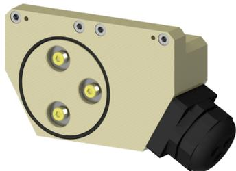
Module électrique côté robot pour S3/S5- 3 contacts de puissance avec PG36 et insert 3 trous diam 12.5mm pour câble 3x35<sup>2</sup> séparés.
