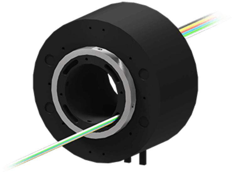
Collecteur tournant pour la transmission de signaux de puissances et/ou de contrôle-commande avec axe creux pour passage d'arbre ou de joint tournant. L'option E1m/E1G offre un canal Ethernet (100BASE-TX ou 1000 BASE-T) sur câble Cat5e et l'option OP1/OP2 permet l'utilisation joint tournant pneumatique intégré tout en transférant 6 à 24 circuits de puissances.
