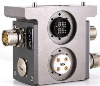
Les modules d'interface pour les réseaux et bus de terrain, ainsi que ceux pour les résolveur ou encodeur, sont encapsulés dans des enceintes métalliques pour offrir un blindage optimum. Ainsi, tout bruit électromagnétique est drainé par la mise à la terre. Tout risque de défaut par une perturbation non récurrente est écarté.
